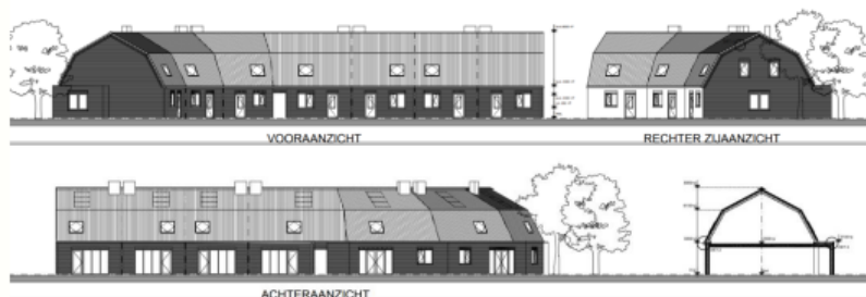
Figuur 7: Gevelaanzichten en doorsneden
